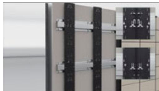
Omegaprofil mit Al-Blindniete Art. 658 oder A4-Edelstahlschraube Art. 659 befestigen (Fest- und Gleitpunkt beachten)
