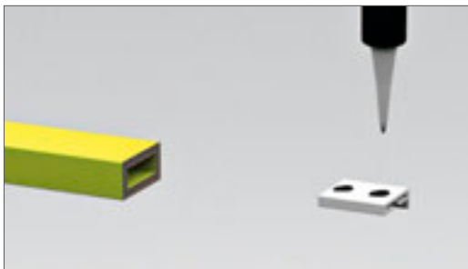
Einbauteil-Halter punktuell mit PUR-Kleber einkleben
