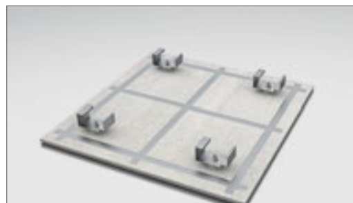
Agraffen mit Gummischeibe Art. 371 und Edelstahlmutter Art. 370 auf die rückseitigen Quadro-Befestigungspunkte schrauben
