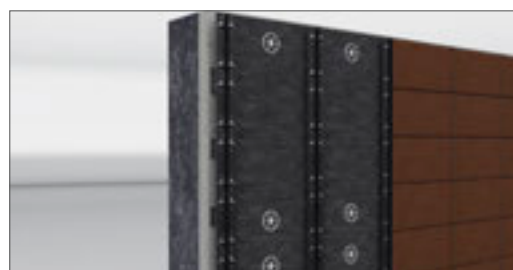
T-Profil mit zugelassenen Befestigungsmitteln montieren
