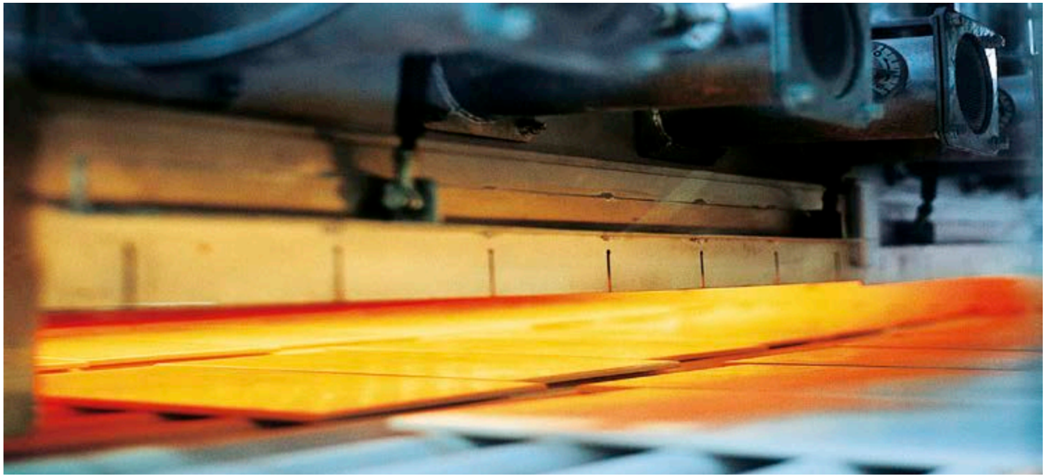
Il rivestimento Hytect viene saldato indissolubilmente con la superficie ad altissime temperature
