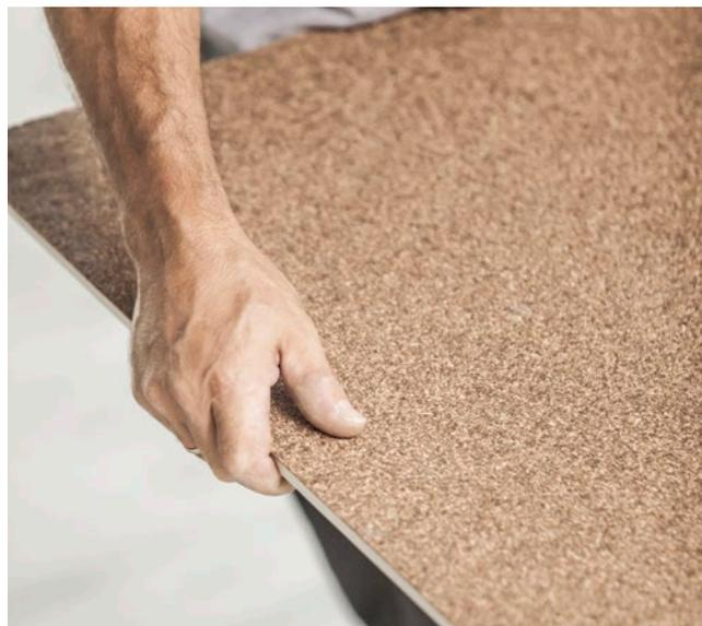
L'option DryTile est disponible pour les carreaux de sol de la série Area Pro, pour la plupart des formats compris entre 30 x 60 cm et 60 x 120 cm. DryTile est une technologie innovante qui consiste à appliquer un composé de liège au dos des dalles. Grâce à ce composé, les dalles peuvent être directement posées sur une surface plane, sans colle.
