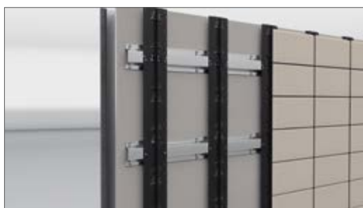
Inserire il profilato per giunti (per giunti chiusi)
