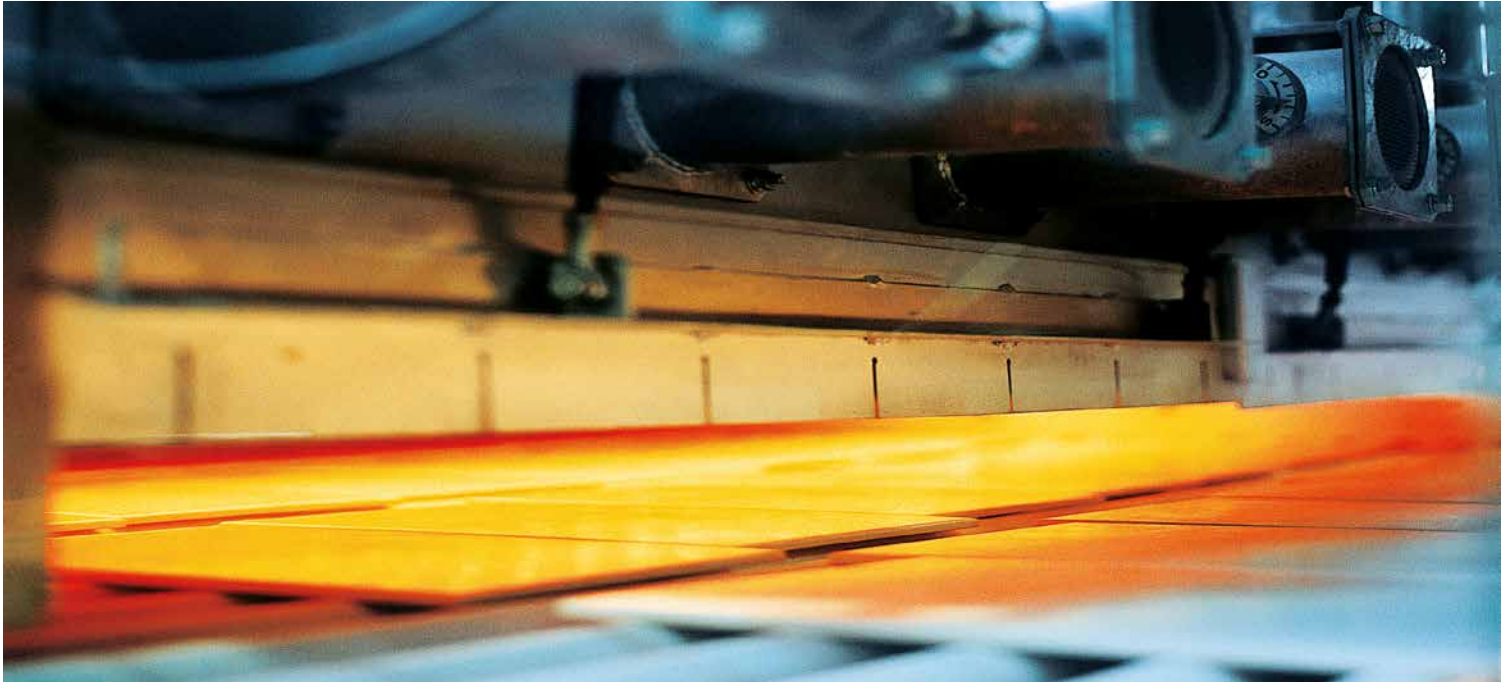
Hytect wird untrennbar in die Oberfläche eingebrannt.
