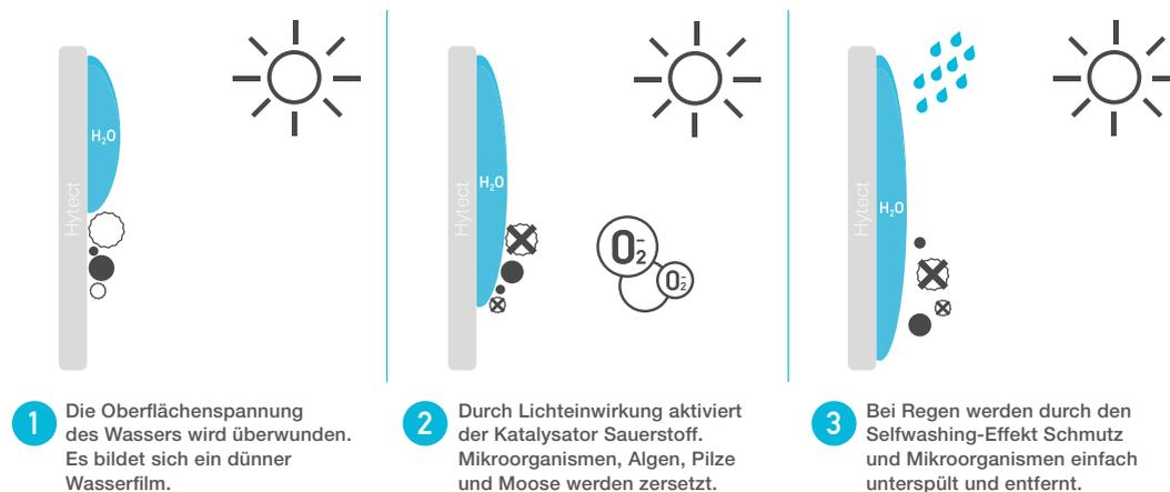
So funktioniert der Self-Washing-Effekt\* von Hytect: Bei Regen bildet sich ein feiner Wasserfilm auf der Oberfläche der Hytect-Keramik. Dieser unterwandert Schmutz und feinste Staubpartikel.
