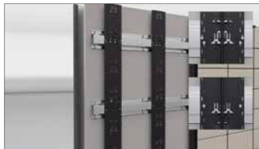
Fissare il profilato Omega con rivetto cieco Al, art. 658, o vite in acciaio inox A4, art. 659 (attenzione a punto fisso e scorrevole)
